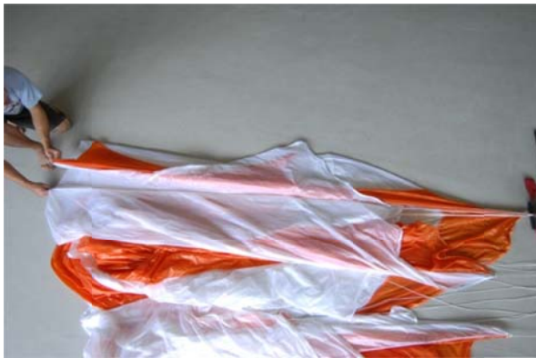
Abb. 34 Bahn Nr. 1 mittels doppeltem S-Schlag reduzieren
