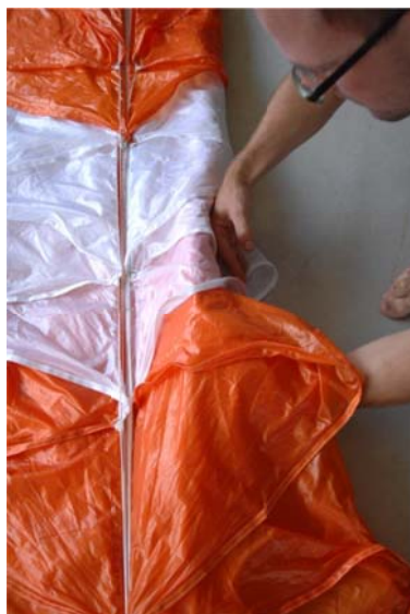
Abb. 71-73 Flügelseite halbieren und unter den Schirm schlagen
