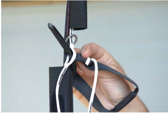
Abb. 3 Verkürzen der Steuerleine für die angebremste Öffnungsstellung. Steuergriffposition „hoch“, Befestigung an der Frontaufhängung
