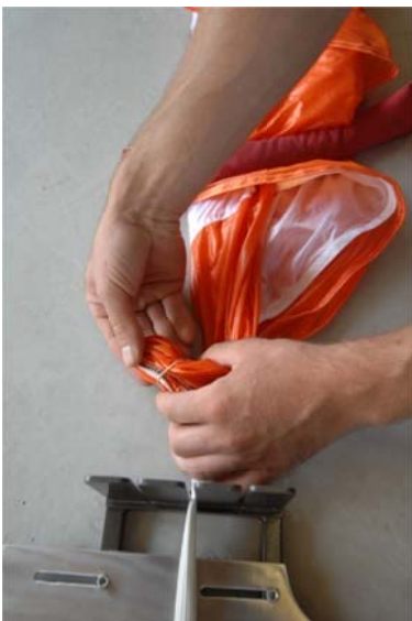
Abb. 85-86 ...mit einem Gummi sichern und auf die Kappe legen
