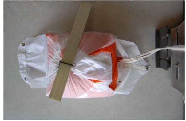
Abb. 96 Wichtig: das Rettungsgerät muss beim Öffnen des ersten Containerblattes komplett freigegeben werden!
