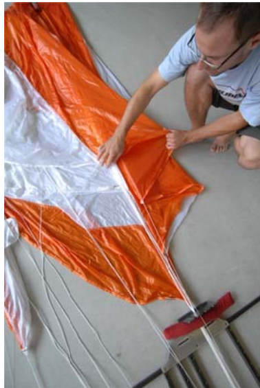
Abb. 51-52 Das Falten der folgenden Bahnen erfolgt bis zur Schirmspitze gemäss Beschreibung der Bahnen 3, 4 & 5
