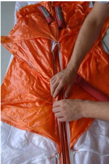
Abb. 68 Kontrolle freier Verlauf der Leinen...
