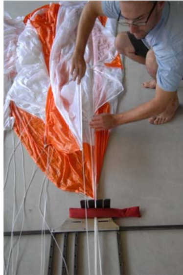
Abb. 39 Leine Bahn Nr. 3 im Faltrechen fixieren
