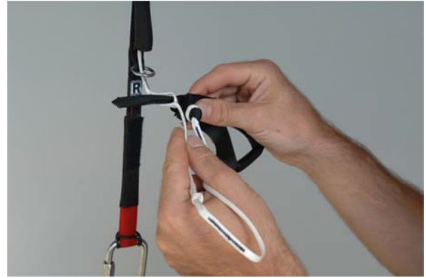
Abb. 4 Verkürzen der Steuerleine für die angebremste Öffnungsstellung. Steuergriffposition „tief“, Schultergurtverbindung
