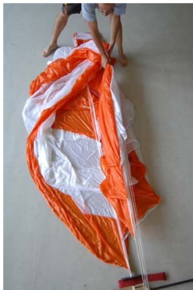
Abb. 63-64 gegenüberliegende Flügelhälfte inkl. Leinen über den Faltrahmen auf die andere Seite legen
