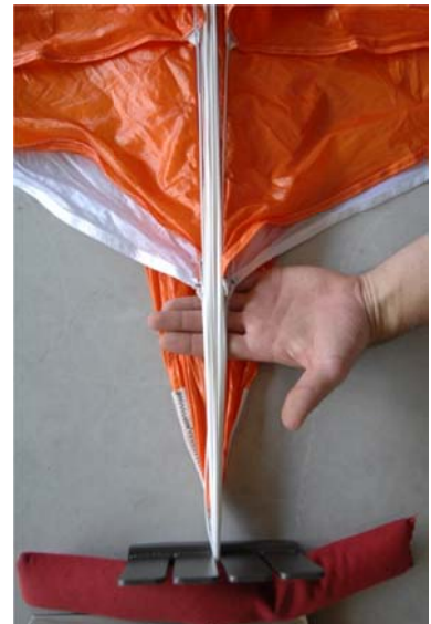
Abb. 70 Sämtliche Leinen müssen auf dem Segel in der Mitte liegen
