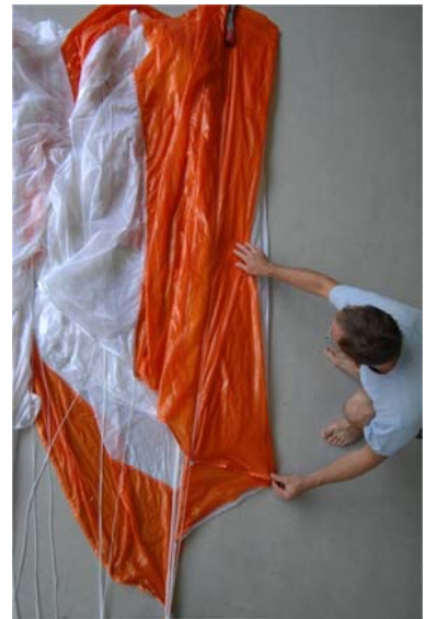
Abb. 48-49 Bahn Nr. 4 nach aussen streichen (S-Schlag)
