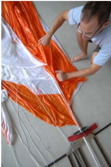
Abb. 50 Leine Bahn Nr. 5 im Faltrechen fixieren
