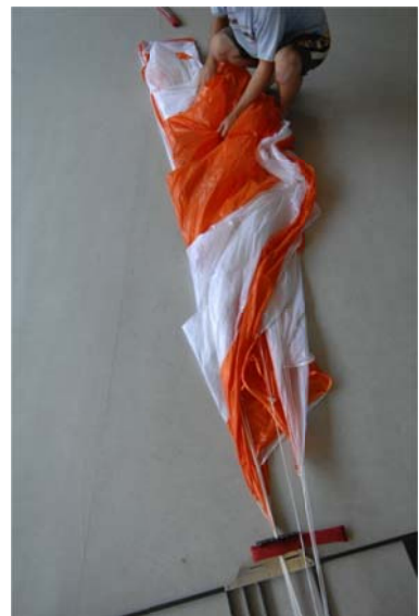
Abb. 63-64 gegenüberliegende Flügelhälfte inkl. Leinen über den Faltrahmen auf die andere Seite legen
