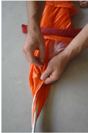
Abb. 82-84 Gesamtes Leinenbündel mit der 1. Bahn einwickeln...
