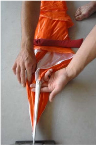
Abb. 82-84 Gesamtes Leinenbündel mit der 1. Bahn einwickeln...
