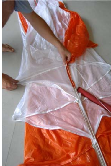
Abb. 66 identisches Falten der gegenüberliegenden Seite...
