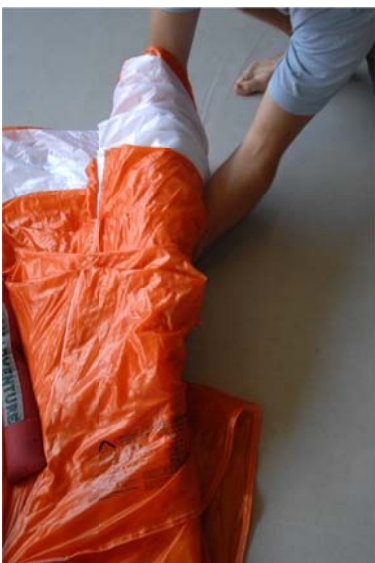
Abb. 71-73 Flügelseite halbieren und unter den Schirm schlagen
