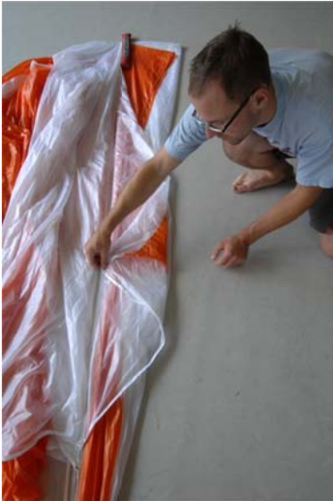
Abb. 38 Bahn Nr. 2 mittels S-Schlag reduzieren
