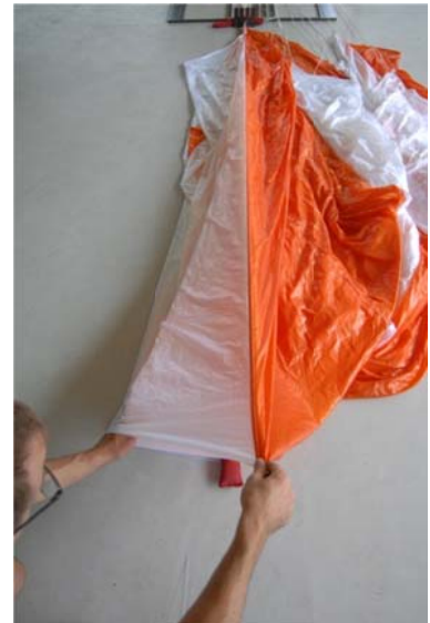
Abb. 43 unter Spannung nach oben auf Bahn Nr. 2 legen
