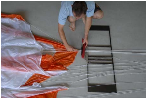
Abb. 32 Leine von Bahn Nr. 1 im Faltrechen fixieren
