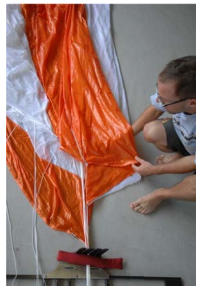
Abb. 45-46 Leine Bahn Nr. 4 im Faltrechen fixieren
