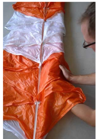
Abb. 70 Sämtliche Leinen müssen auf dem Segel in der Mitte liegen
