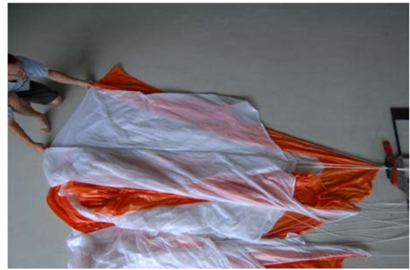
Abb. 33 Bahn Nr. 1 auslegen und darauf achten, dass die Leine auf die Mittelleinen und zugleich auf die Geräteachse zu liegen kommt
