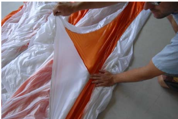
Abb. 36 Leinenansatzpunkt Bahn Nr. 2 auf die Mittelleinen legen und mit der Hand fixieren
