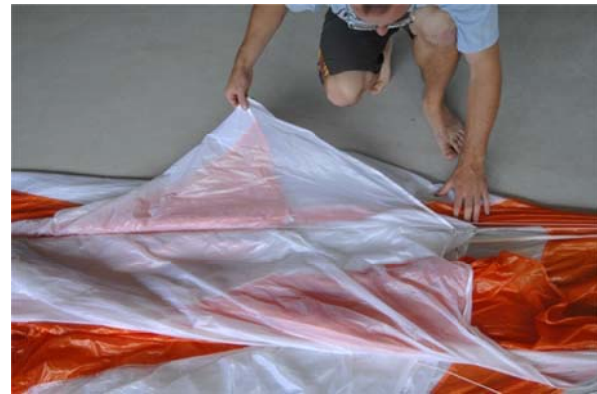
Abb. 35 Leine Bahn Nr. 2 im Faltrechen fixieren
