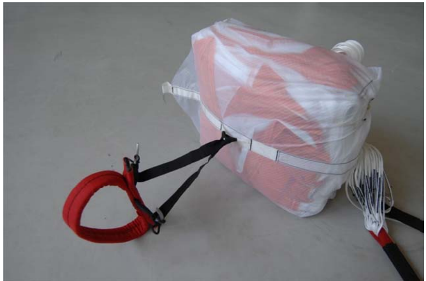
Abb. 112 Griffbefestigung für Frontcontainer
