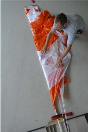
Abb. 65 Die Mittelleinen bilden die Symmetrieachse
