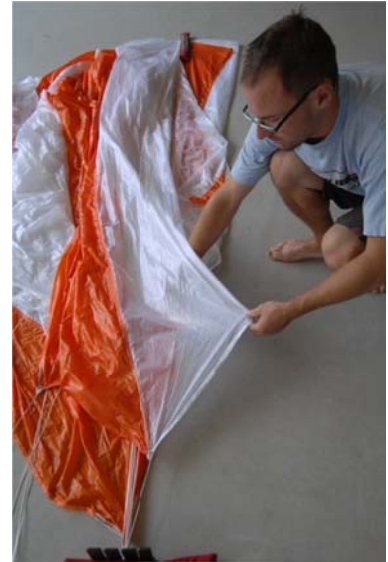
Abb. 40 Leinenansatzpunkt Bahn Nr. 3 auf die Mittelleinen legen
